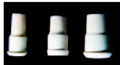
Figura 5: Pilares de alumina/zircônia/vidro disponíveis no mercado para implantes de diferentes diâmetros [10].
