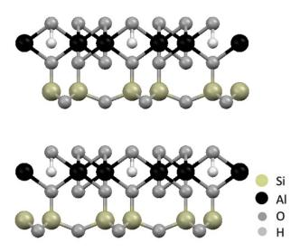
Figura 1. Estrutura da camada 1:1 da caulinita, com uma folha de tetraedros de SiO<sub>4</sub> e outra de octaedros de Al<sub>2</sub>(OH)<sub>6</sub>
