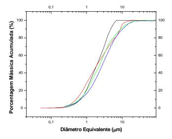
Figura 5. Distribuição de tamanho de partícula de argilas "ball clays" paraibanas
