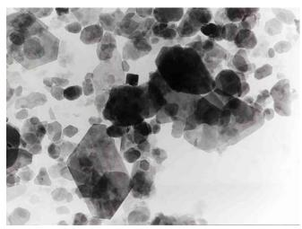
Figura 3. Microscopia eletrônica de transmissão de argilas "ball clays" paraibanas (barra com valor de  $0.5~\mu m$ )
