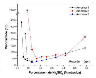
Figura 7. Curvas de defloculação de argilas "ball clays" paraibanas
