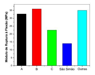
Figura 6. Módulo de ruptura à flexão após queima a 1250°C de argilas "ball clays"
