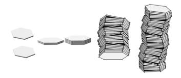
Figura 2. Representação esquemática do empilhamento de camadas 1:1 na caulinita
