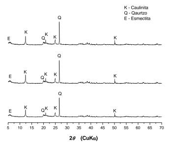
Figura 4. Difratograma de raios X de argilas "ball clays" paraibanas
