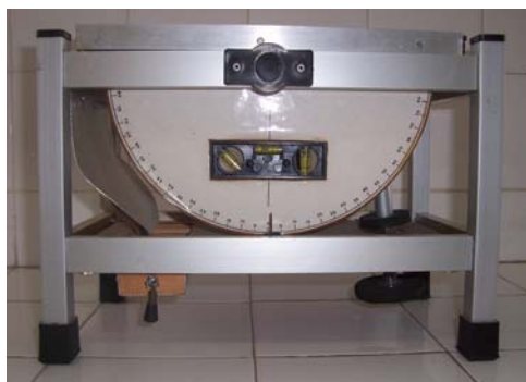
Figura 2: Plataforma para medida de ângulo de repouso
