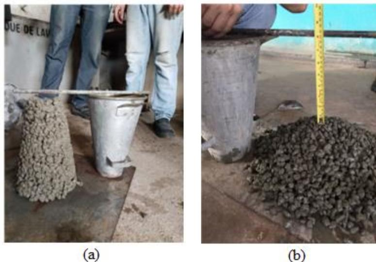
Figura 3: (a) Abatimento do traço T1, Slump 0; (b) Abatimento do traço T2, com aumento de fluidez devido a adição de superplastificante.
