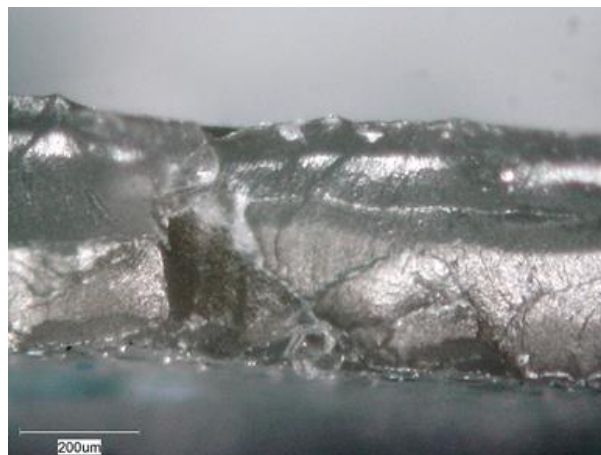
Figura I - Superfície de fratura de amostra de membrana após rompimento no ensaio de resistência a tração do PB16, com magnificação de 300X.
