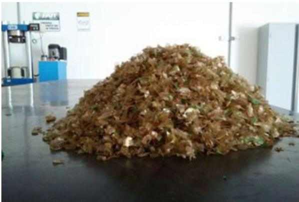
Figura 1: Flocos de “PET Oil” utilizados na preparação dos “pavers”
