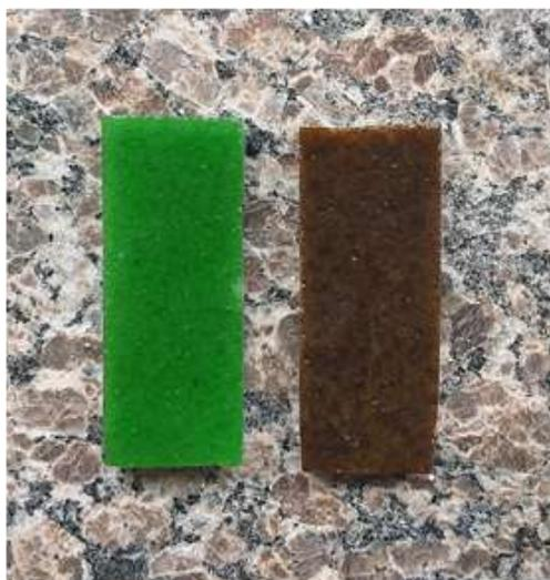
Figura III: Pastilhas em tamanhos 6cm x 2cm, após corte e lixamento lateral.
