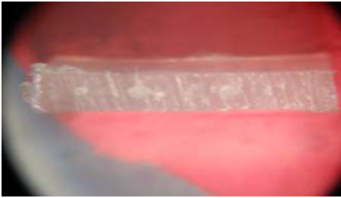
Figura VI. Estereoscopia de seção de corpo de prova com 3 mm de espessura, 2% de aditivo e molde a 20°C.
