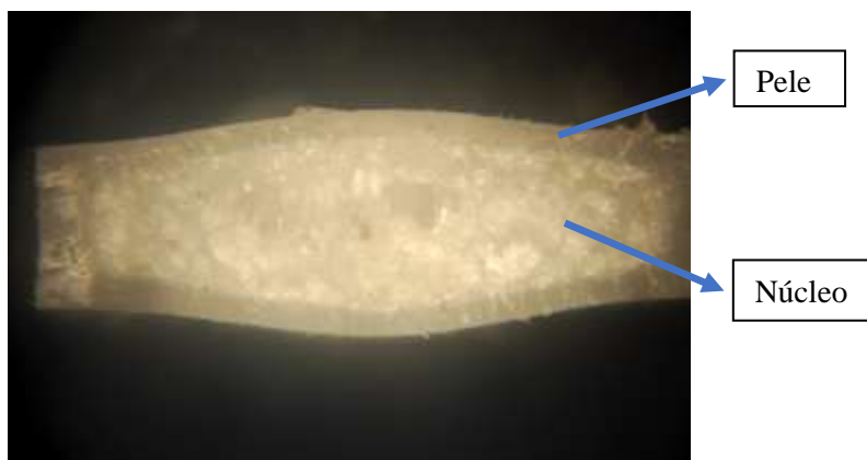
Figura IV. Estereoscopia de seção de corpo de prova com 4,5 mm de espessura, 4% de aditivo e molde a 20°C.
