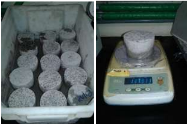
Figura 6: Teste de absorção de água.
