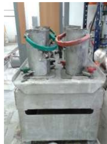
Figura 5: Adensamento do concreto na mesa vibratória
