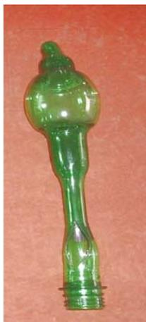
Figura 3 – Garrafa de PET após etapa de sopro utilizando-se uma pré-forma que cristalizou parcialmente durante o aquecimento. Note que a transformação foi altamente heterogênea, com algumas regiões pouco deformadas.
