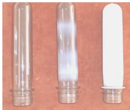
Figura 2 – Pré-formas de PET amorfa, parcialmente cristalina e cristalina (da esquerda para direita).
