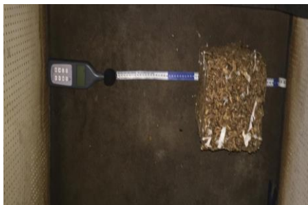
Figura 2 - Caixa com posicionado com a distância para o decibelímetro. Fonte: Autor (2019).
