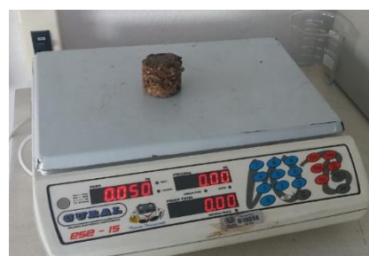
Figura 1 - Amostras de corpos de prova de compósito de rejeito lignocelulósico. Fonte: Autor (2019).
