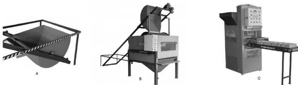
Figura III – Máquina para moldagem do tijolo solo-cimento: (A) padiola, (B) misturador e (C) prensa.
