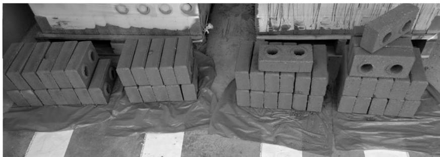
Figura IV – Tijolos após procedimento de moldagem.
