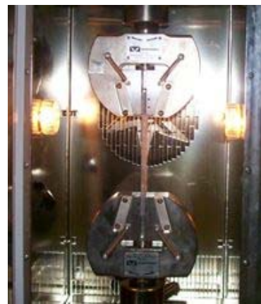
Figura 3. Corpos de prova preparados para o ensaio de tração.
