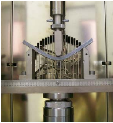
Figura 4. Corpo de prova sendo rompida no ensaio de flexão .
