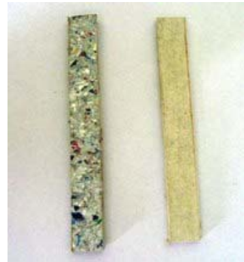
Figura 2. Corpos de prova confeccionados para a realização dos ensaios mecânicos.
