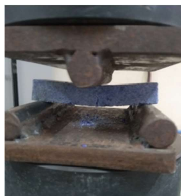
Figura 4 - Pulser SFL-100kN da Schimadzu durante a realização do ensaio de Flexão em três pontos.
