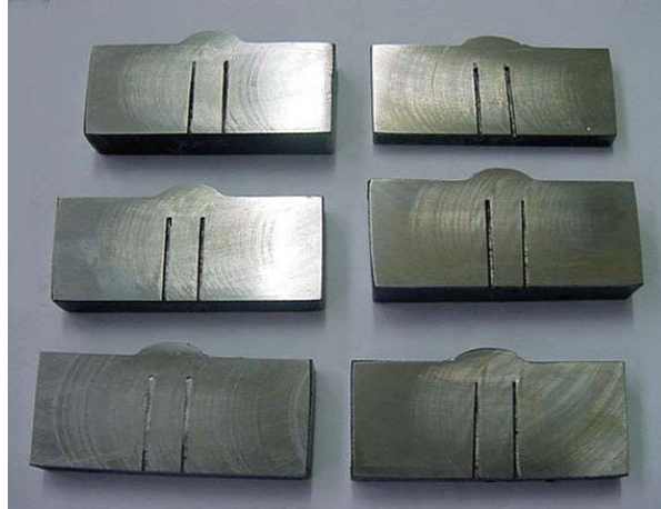
Figura 2 – Corpos de prova a serem preparados para análise metalográfica. Vê-se os furos de inserção dos termopares.
