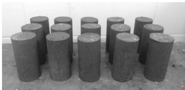
Figura 7 – Corpos de Prova após confecção
