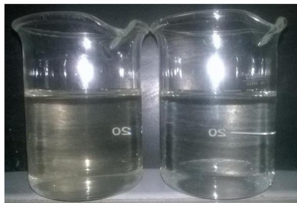
Figura 4 - Imagens capturadas do efluente bruto do rio Gramame (a) e do mesmo efluente após ser permeado pela membrana (b).
