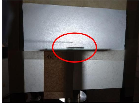
Figura 7 – Molhabilidade por medida de ângulo do contato das amostras.
