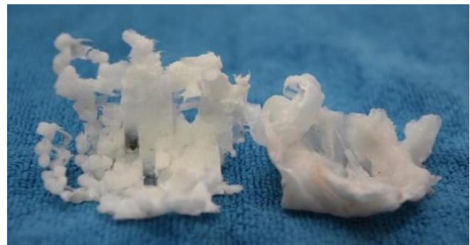
Figura 22 – Carcaça extraída da rosca no primeiro bloco de malaxagem configurado, ilustrando a fusão do polipropileno. Na extrema esquerda observam-se pellets soltos no início do processo de fusão, seguidos da massa de polímero parcialmente fundido, com as marcas dos discos de malaxagem. Na extrema direita o polipropileno totalmente fundido preenche parcialmente a câmara de processamento.
