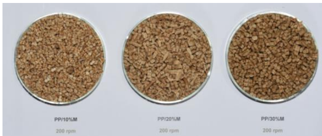
Figura 20 – Efeito do teor de carga na cor dos pellets do compósito PP/pó de madeira extrudados a 200 rpm.
