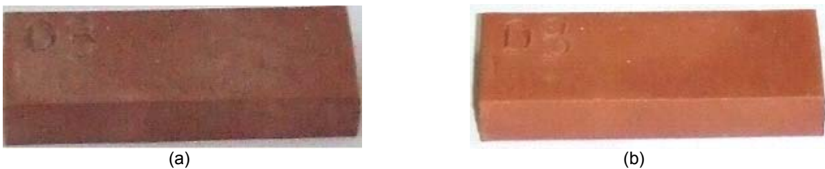
Figura 15. Comparação do corpo de prova CPD3110, antes (a) e depois (b) do choque térmico, com temperatura de secagem 90°C e de queima 950°C.
