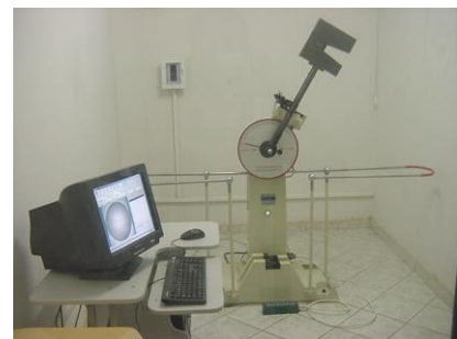
Figura 3. Máquina de ensaio Charpy.
