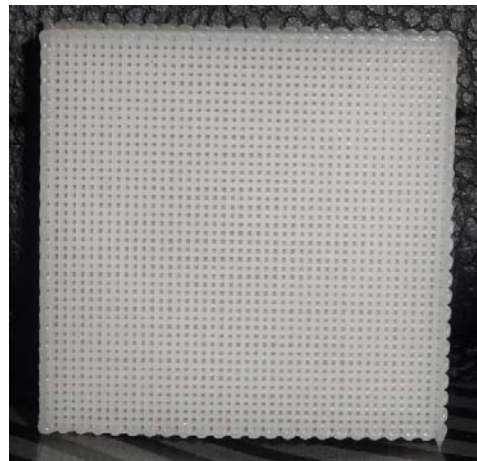
Figura 2. Estrutura tridimensional obtida a partir do sistema BioExtruder
