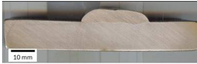
Figura 4. Revestimento com o maior nível de diluição (9,61±0,54 %)
