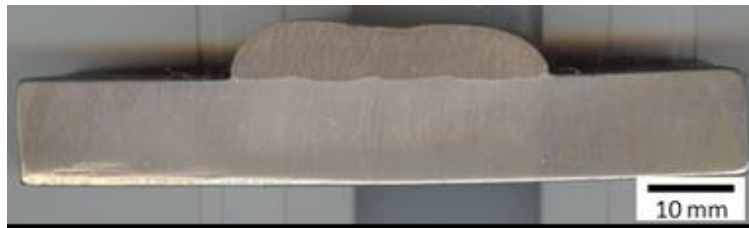
Figura 3. Revestimento com o menor nível de diluição (5,37±1,08 %)
