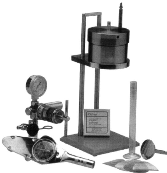
Figura 2. Equipamento de prisão diferencial, *Differential Sticking Tester* [14]
