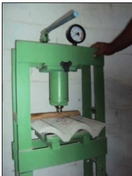
Figura 3. Demonstração do ensaio de ruptura a flexão.
