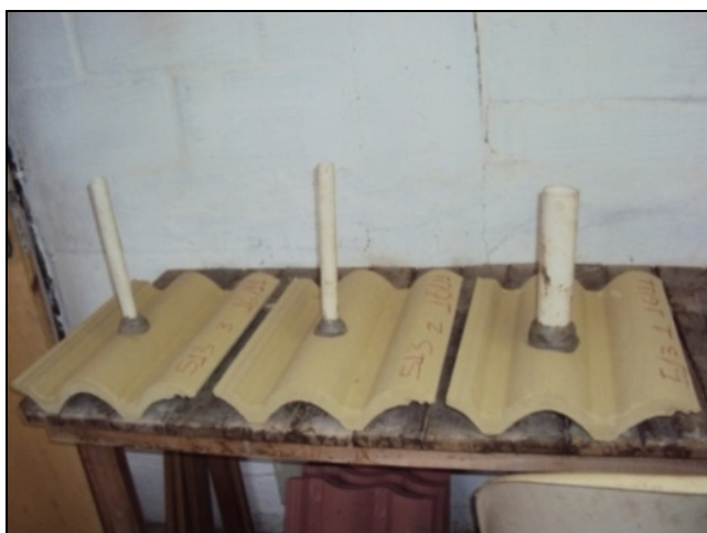
Figura 2. Demonstração do ensaio de permeabilidade.
