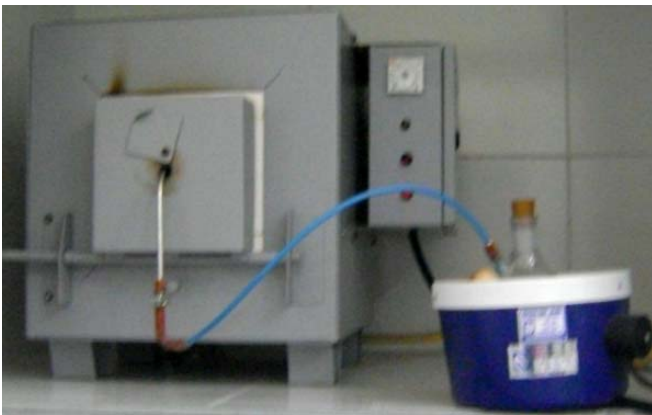
Figura 2. Esquema montado para a realização do teste de estabilidade hidrotérmica 800°C/5h.
