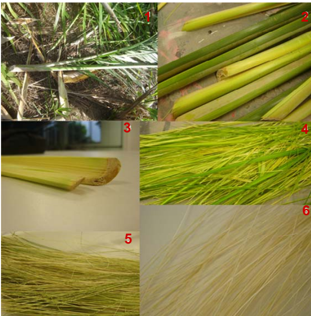
Figura 3. Processo de obtenção das fibras das folhas da palmácea . (1) Local onde fica o palmito. (2) e (3) Parte da folha em que é retirada a fibra. (4) Fibras Separadas. (5) Separação das parte verde. (6) Fibras raspadas com faca
