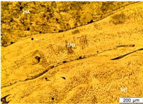
Figura 13. Micrografia apresentando o metal de solda, zona parcialmente diluída (ZPD) e a ZTA do revestimento SAW – 9. Ampliação: 100x
