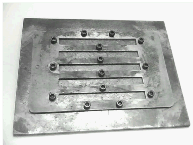
Figura 2. Molde metálico confeccionado com cavidades retangulares de 125,0x12,7x3,2 mm correspondentes ao formato de corpos de prova tipo flexão (ASTM D790)
