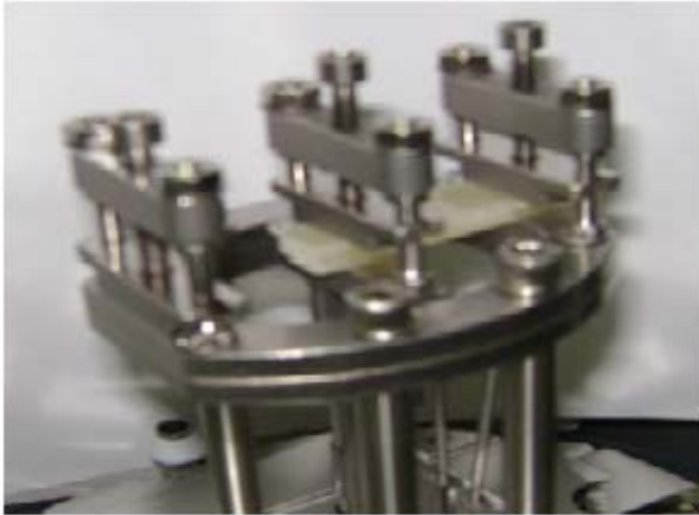
Figura 3. Suporte para amostra em modo de viga simplesmente engastada
