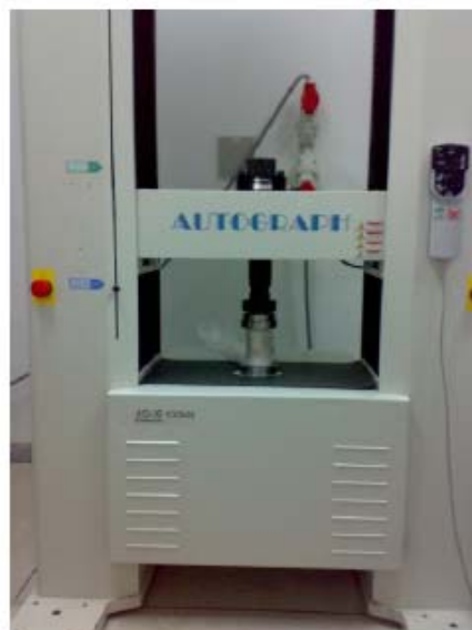
Figura 3. Máquina Universal da marca Autograph da Shimadzu AG-IS 100 kN
