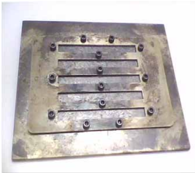
Figura 3: Molde metálico confeccionado com cavidades retangulares de 125,0x12,7x3,2 mm correspondentes ao formato de corpos de prova tipo flexão (ASTM D790)
