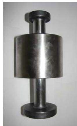
Figura 4 – Matriz de compactação de amostra cilíndrica.
